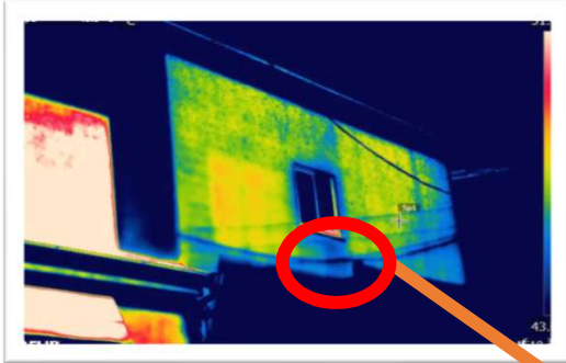
窓下の断熱材が欠損
